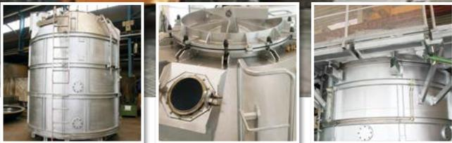
Bei der Großserienproduktion von Gussteilen aus Aluminium-Silizium-Legierungen für die Automobilindustrie speichert der Ofen das angelieferte flüssige Metall und hält es exakt auf der vorgegebenen Temperatur.
