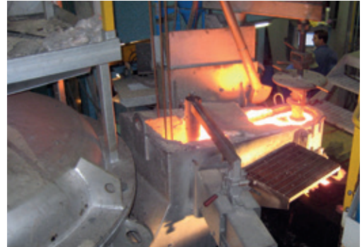
Ausgussschnauze mit Schwimmersystem und schnell wechselbarem Stopfen
