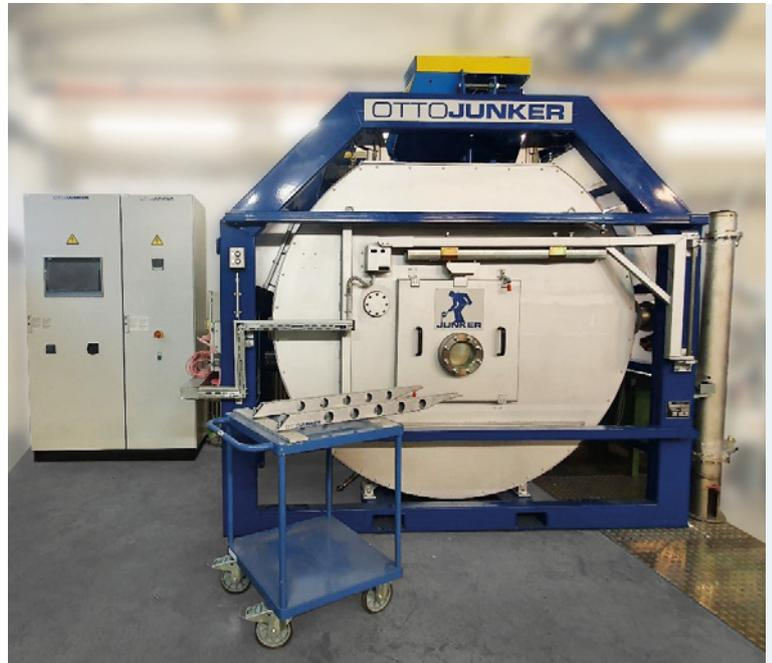
*Pilotanlage für thermisches Recycling von Batterien*
