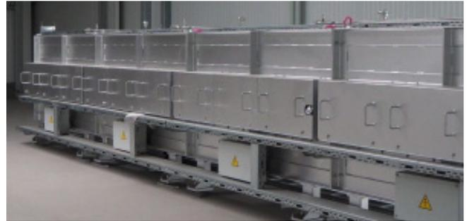
Heizstrecke zur Erwärmung von Luft von 300 °C auf 1.100 °C.
